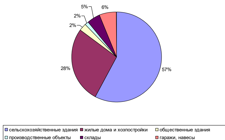
Рисунок 4.3 - Места обрушений кровли
